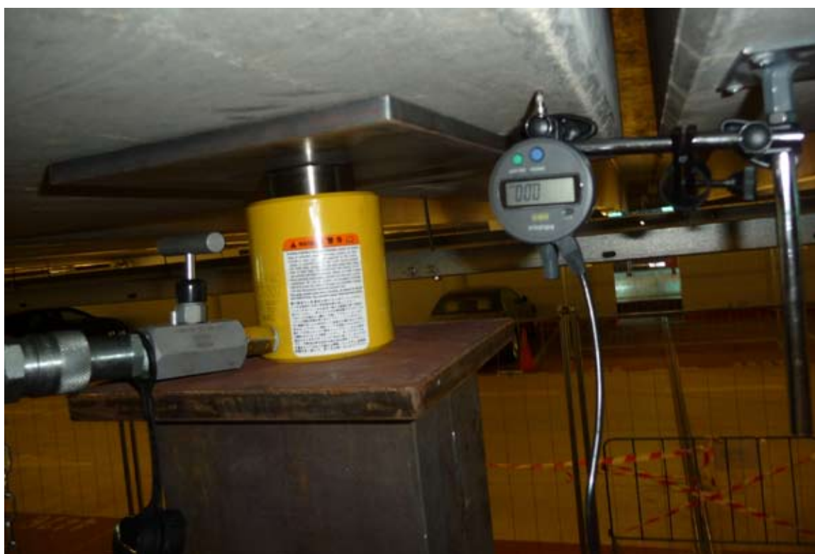
Detail zvedacího zařízení
